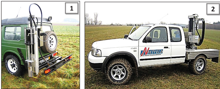
Рис. 3. Ґрунтові пробовідбірники: 1 – Nietfeld 2005; 2 – Nietfeld Duoprob 60
