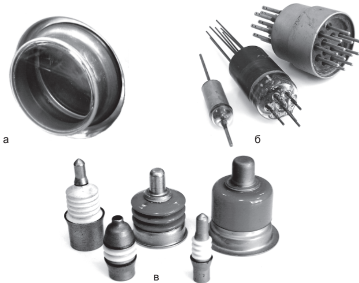
Рис. 1.3. Деталі вакуумних установок з використанням скла та кераміки: а – оглядове скляне вікно; скляні (б) та керамічні (в) струмоводи
